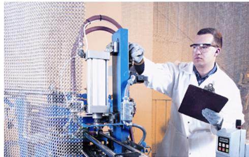
La commande numérique permet de dessiner exactement la forme d'une pièce en en programmant la soudure de chaque anneau, mais une grande partie du travail, l'assemblage des sous-ensembles, reste manuel. Il est réalisé par des ouvrières d'une très grande dextérité. On est proche de la couture...
